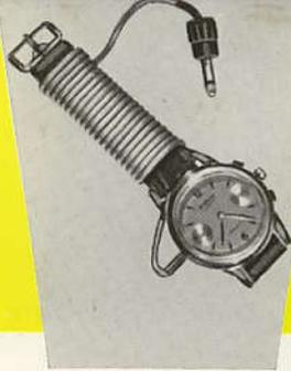
Das **Armbandmikrofon** gestattet volle Bewegungsfreiheit bei der Arbeit, z. B. bei Lagerbestandsaufnahmen, bei ärztlichen Untersuchungen und Markstudien. Das eingebaute hochempfindliche Kristallmikrofon nimmt mit Richtstrahlwirkung bis zu 9 m Entfernung silbenklar auf.
